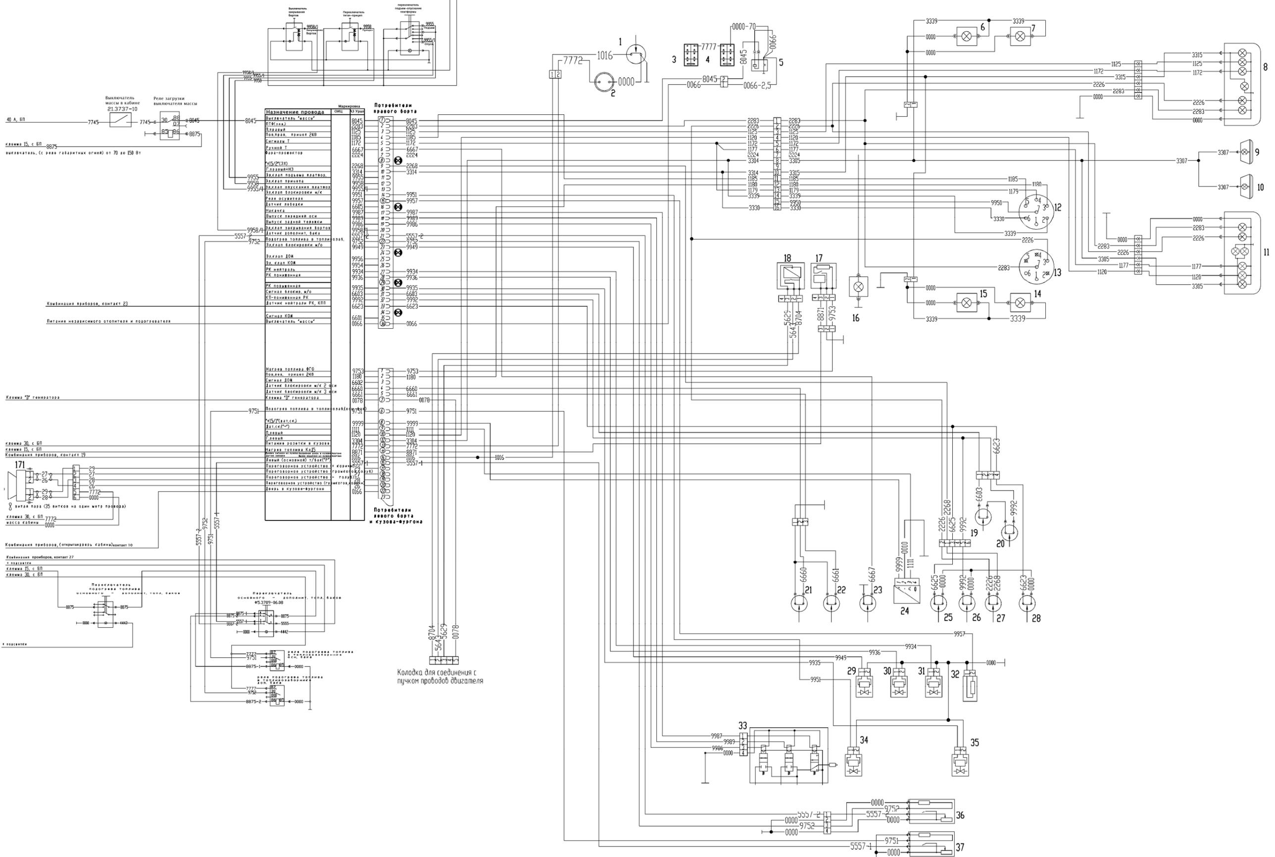
Рисунок А.1 Схема электрооборудования шасси (без кабины) Урал 4320-0006951-74
